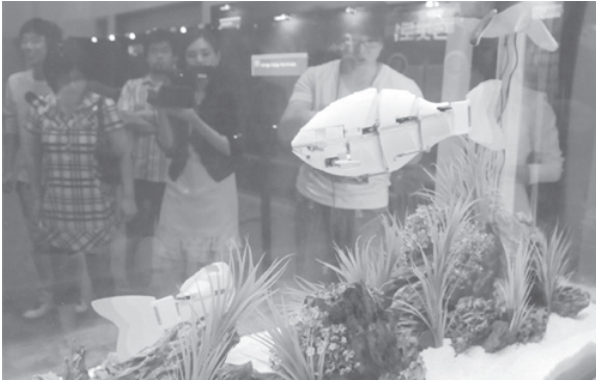
한국생산기술연구원(이하 생기원)의 “익투스 V3”, 42cm 1.2kg, 자율유영, 무선통신, 무선카메라, 적외선 장애물 감지센서 등
