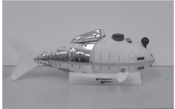
실환경 시험용 “익투스 V5.5”, 55cm, 4.2kg, USBL(Ultra Short Base Line), 관성항법장치 및 GPS 기반 위치인식시스템, 초음파 및 전파통신, 수질센서, 적외선 및 초음파 장애물 감지 센서 등
