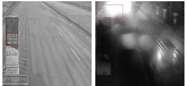
그림 8. 킨텍스IC 입간판 신규설치 및 빗물 왜곡에 의한 오검지 유형
