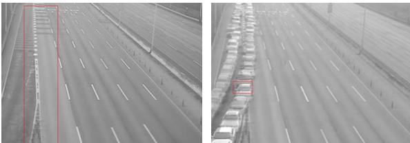
그림 10. 바람으로 인한 카메라의 흔들림, 램프 진출 정체에 의한 오검지 유형
