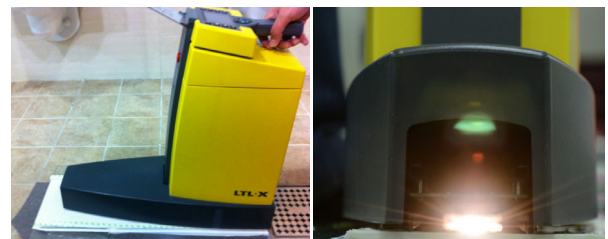
그림 7. 노면표시 재귀반사 측정
