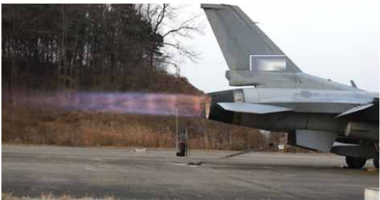
Fig. 8. 계측 포드 지상 공력 음향시험
