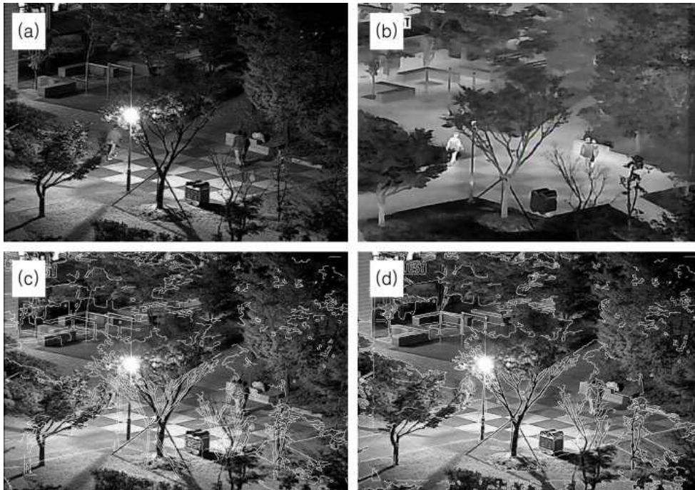
그림 5. (a) 가시광선 영상 (b) 적외선 영상 (c) 정합 전 영상 (d) 정합 결과 Fig. 5. (a) EO and (b) IR images. (c) Image before registration and (d) Registration result
