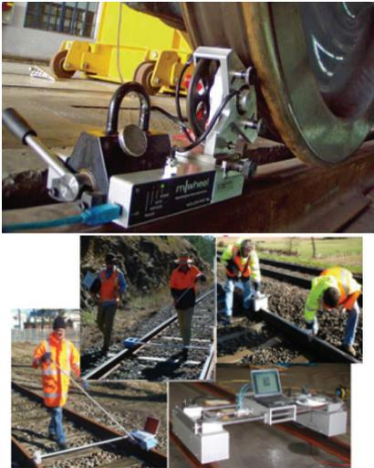
[그림 5] 차륜 및 레일의 표면 음향조도 측정장비 및 측정모습
