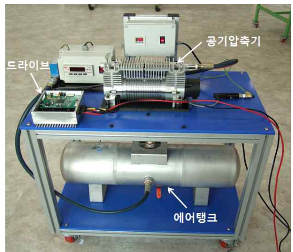
그림 12. 공기 압축기 특성시험 간이장치 Fig. 12. Characteristic test for air-compressor simplified equipment
