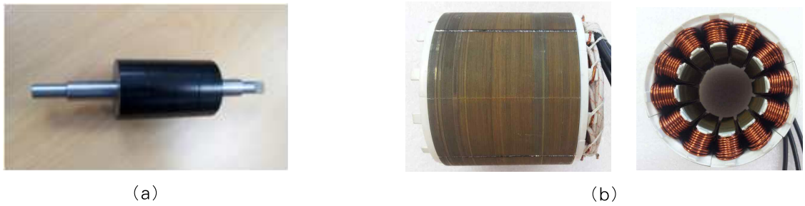
그림 6. 브러시리스 직류전동기의 시제품 (a) 회전자 (b) 고정자 Fig. 6. Prototype of BLDC motor (a) rotor (b) stator
