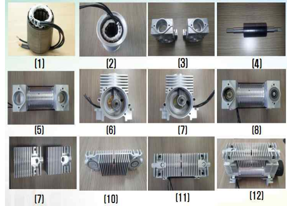
그림 11. 공기압축기 조립 과정 Fig. 11. Air-compressor assembly process
