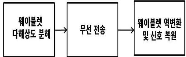
그림 8. 지그비 무선 통신에 의한 압축 데이터의 전송 및 복원 Fig. 8. Data compression and reconstruction by using Zigbee wireless communication
