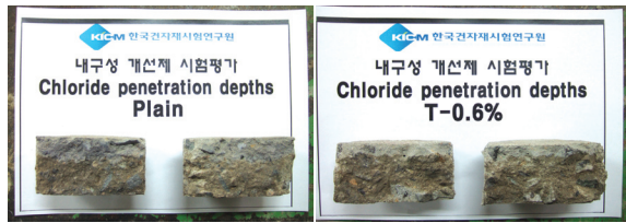
(a) Plain(통과전하량 : 1,321C, 침투깊이 : 16.52mm) (b) PHDC-0.6(통과전하량 : 1,015C, 침투깊이 : 7.20mm)
