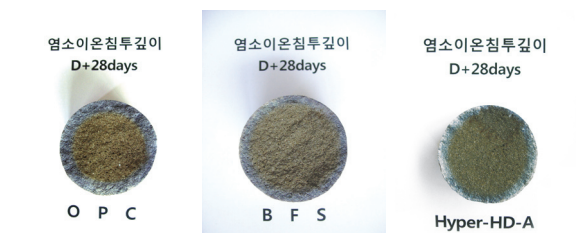
(a) OPC (침투깊이 : 9.55mm) (b) BFS (침투깊이 : 7.51mm) (c) PHDC (침투깊이 : 6.06mm)
