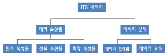
〈그림 7〉 ITS 메시지 체계 〈Fig. 7〉 ITS Message Set
