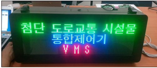
〈그림 15〉 데이터 송수신 확인 〈Fig. 15〉 Conformation of VMS Emulator Transmission
