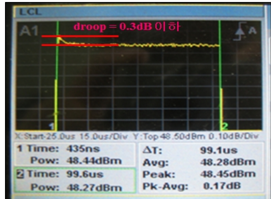
그림 14. X-대역 전력 증폭 모듈의 펄스 특성 Fig. 14. The pulse characteristic of SSPA module.
