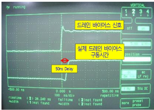
그림 6. 드레인 스위칭 회로의 측정 결과(상승 시간) Fig. 6. The measurement result of drain switching circuit(rising time).
