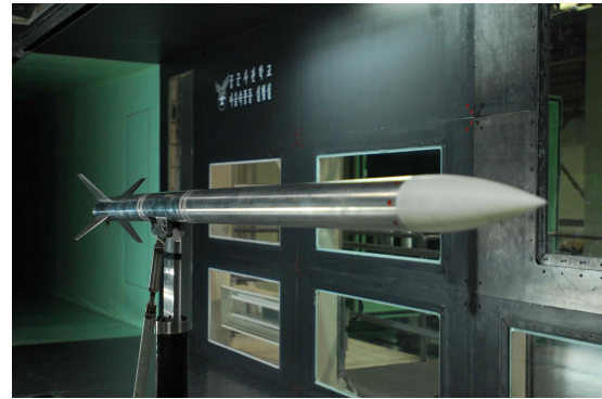
Fig. 1. 과학로켓 50% 축소 모델과 풍동 자유진동 실험장치[단위:mm]
