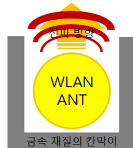
그림 3. 지향성으로 구성된 무선랜 안테나 방식 Fig 3. Configured with directional wireless LAN antenna
