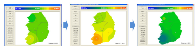
그림 10 2상(b, c상) 단락 시뮬레이션 진행 화면 Fig. 10 Simulation result for double line-to-ground fault between Yeonggwang and Shinkwangju
