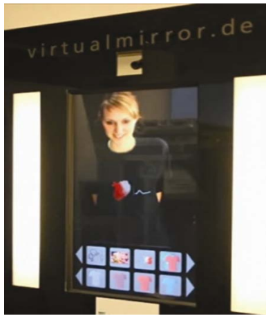
(그림 6) Fraunhofer의 연구팀에서 개발한 Virtual Mirror
