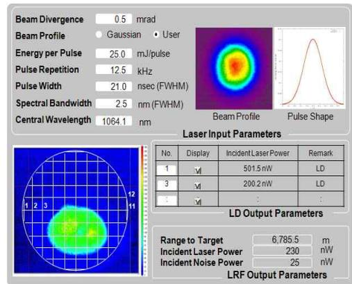
그림 15. 레이저 M&S GUI
