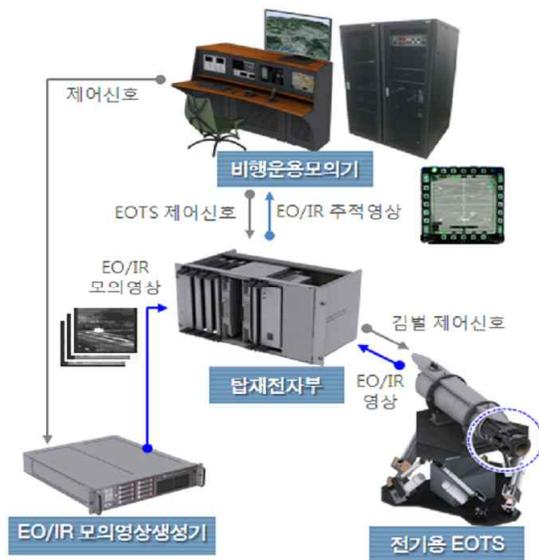
그림 1. 전자광학 타겟팅 시스템 HILS
