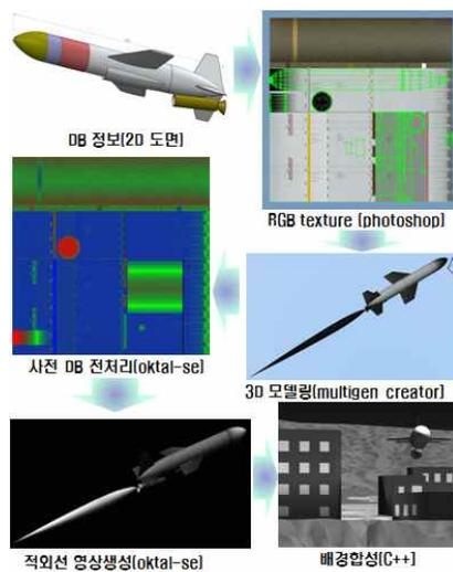
그림 4. FAST-IR 모델링 과정
