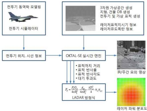
그림 13. OKTAL-SE를 활용한 IR 영상 및 레이저특성 모의
