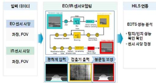
그림 3. EO/IR 센서 모델링
