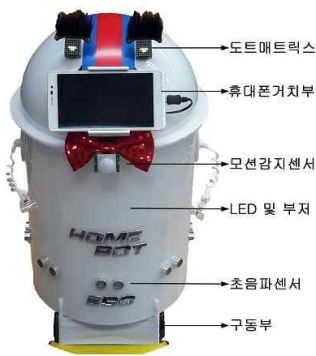
Fig. 5. Homebot body 그림 5. 홈봇 몸체
