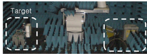
(a) 모식도 (a) Experimental setup (b) 실제 사진 (b) Photograph of experimental setup 그림 7. 금속 평판에 대한 모노스테틱 능동 상쇄 실험 환경 Fig. 7. Mono-static experimental setup for metallic plate.
