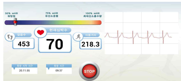
그림 5 바이오 셔츠를 착용하고 운동 시에 가속도, 심전도 신호, 심박 수, 걸음 수 및 운동거리를 실시간으로 보여주는 태블릿 화면
