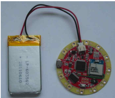
그림 13. 충전용 배터리를 연결한 시스템
