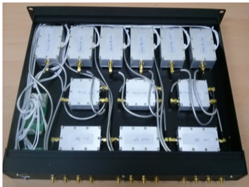
그림 5. 구현한 modular 3-Band RF 부 (100/400/800MHz) Fig. 5. Implemented modular 3-Band RF part (100/400/800MHz)
