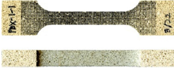
Fig. 3. 격자가 표시된 복합화약 시뮬란트의 단축인장 시편
