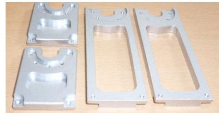
그림 5. 제작된 하체부의 고관절에 사용되는 프레임. Fig. 5. Fabricated frame part used for hip joint of lower body.
