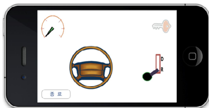
그림 4. 아이폰에서 가속도 센서를 이용하는 무선 제어기 화면 Fig. 4. Control panel in using acceleration sensors in iPhone
