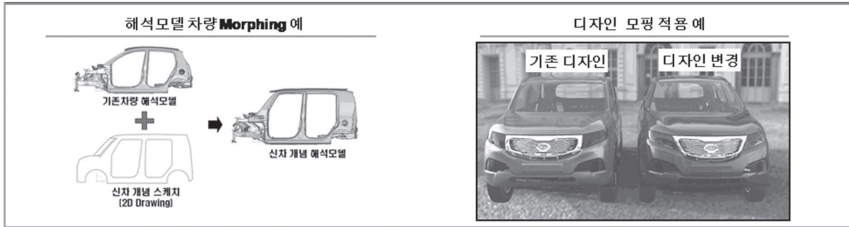
그림 2 개념 모델링 형상 변화 기법(모핑) 사례 : 현대차
