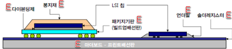
그림 1. 반도체 패키징 형상(좌)과 반도체 패키징에 사용되는 에폭시 소재(우). 에폭시 소재가 사용되는 부분을 E로 표기됨.
