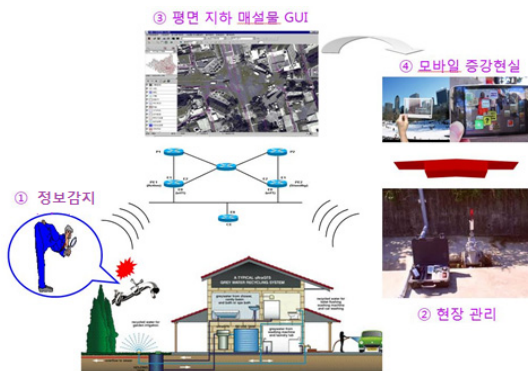
그림 1. 모바일 증강 현실을 이용한 지하 사회 기반 시설 관리 시나리오
