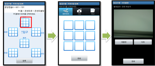
그림 9. 하자 세부 위치 결정 및 사진 촬영 Fig. 9. Defect Locating and Photo Shoot
