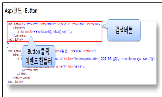
그림 6. 버튼 클릭 이벤트 핸들러 정의 Fig. 6. A definition of a button click event handler
