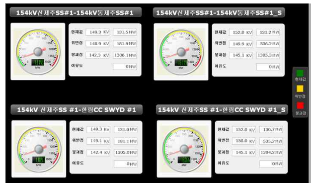
그림 12. 상정사고 시 전압안정도 계산 화면 Fig. 12. Voltage stability analysis view in contingency case
