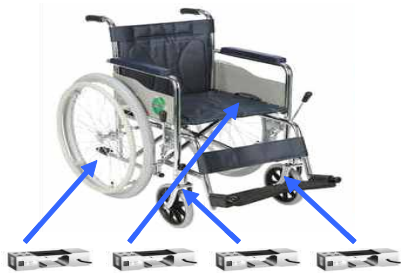
그림 5. 로드셀 휠체어 설치 위치 Fig. 5 Location of Loadcell Installation
