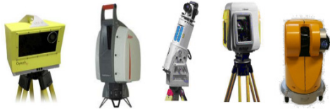
그림 3. Time-of-flight 방식의 스캐너 Fig. 3. The laser scanner based on time-of-flight
