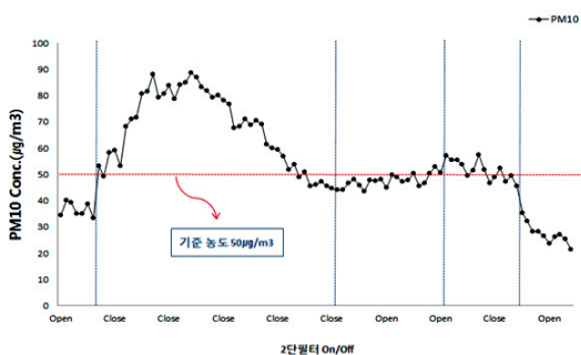
[그림 7] 기준 값에 따른 필터시스템 가동
