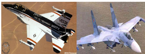
Fig. 1. 공중모의 비행시험기 (좌) F-16 VISTA(미), (우) Su-27 IFS(러)
