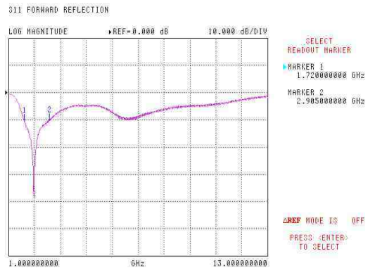
그림 10. 원통 모노폴의 반사특성 측정결과 ( L=3 cm, R=0.48 cm, p=2 mm, 겹각 \approx 0.6 mm)
