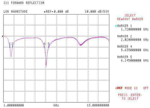
그림 9. 와이어 모노폴 안테나의 반사특성 측정결과 ( L=3.5 cm, R=0.05 cm)
