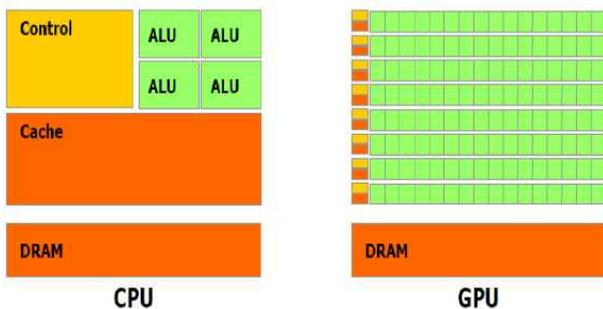
그림 6. CPU & GPU 트랜지스터 자원 배분 비율
