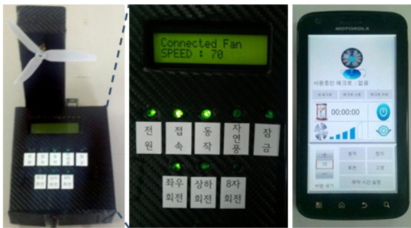
(a) 구현된 선풍기 (b) 선풍기 기본 기능 구현 (c) 앱의 리모컨 기능
