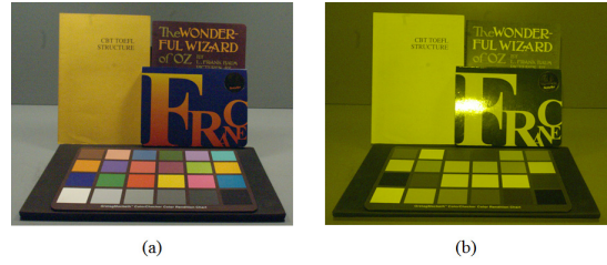
그림 1. 획득 된 멀티 스펙트럴 플래시 영상; (a) 가시광 영상, (b) UV/IR 플래시 영상
