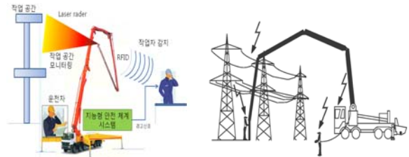
그림 3.6 RFID 작업자 모니터링 및 활선구간 접근 감지 기술
