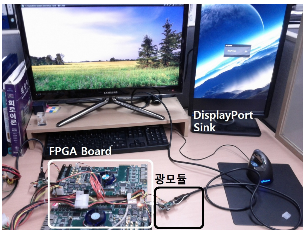
그림 11. 디스플레이포트 소스장치와 싱크장치를 광 채널을 이용하여 연결한 모습 Fig. 11. DisplayPort Source and Sink Connection with Proposed Optical Module.
