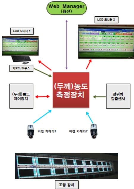
그림 3. 해태(김)두께 측정 및 조절 장치의 전체 구조
