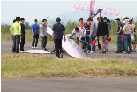
그림 3.1 비행 시험 도중 파손된 기체
