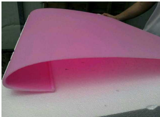
그림 2.3 열선 가공된 주날개용 leading edge cover
