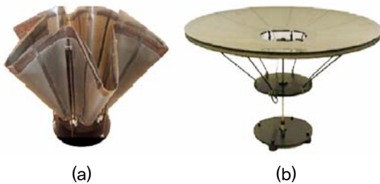
(그림 12) 형상기억고분자 복합체 반사경(a) 변형된 형태(b) 회복된 형태[19]
