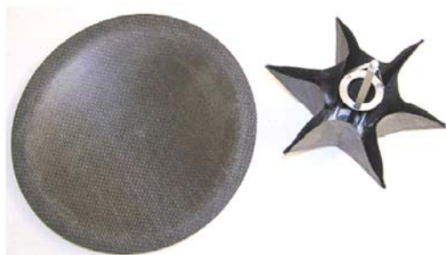
(그림 13) 형상기억고분자 반사경(직경 0.5m)[20]
