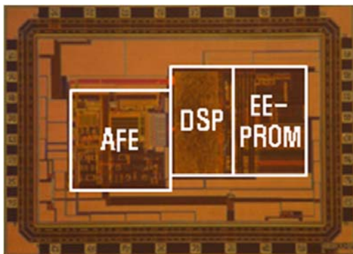
(그림 6) 복합환경센서 신호처리 ROIC 칩사진
