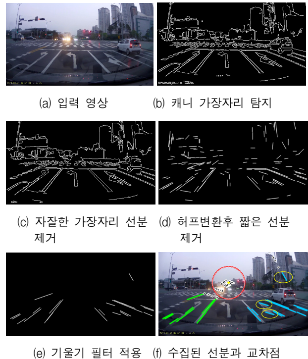
그림 3. 소멸점 탐지를 위한 직선 수집 과정 Fig. 3. Line segment collection for detecting vanishing point.
