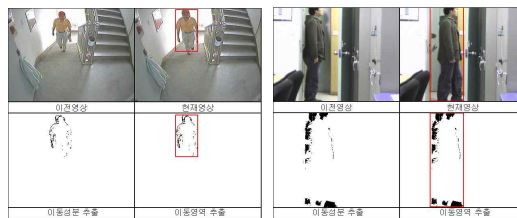
그림 2. 이동 영역 추출 영상 Fig. 2. Extraction of moving area
