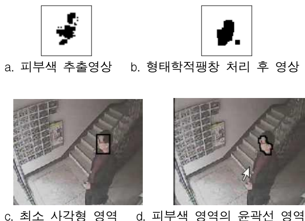
그림 4. 얼굴 영역의 추출 영상 Fig. 4. Extraction Image of face area
