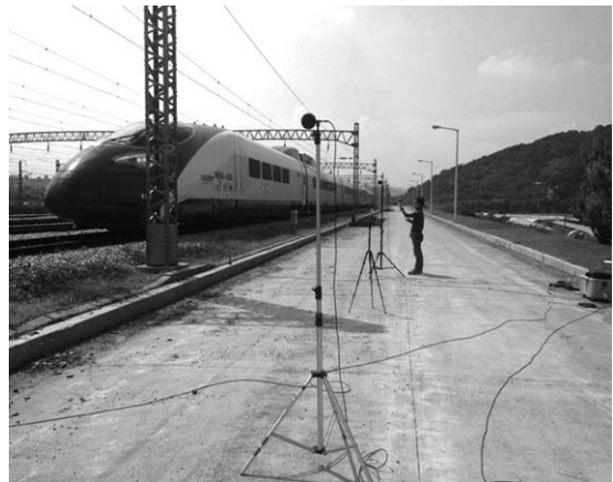
그림 5 고속열차의 저속 운행 시 동력소음 측정
