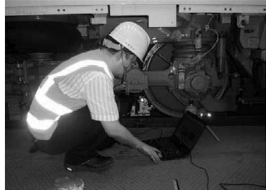
그림 3 철도 차륜 음향조도 측정
