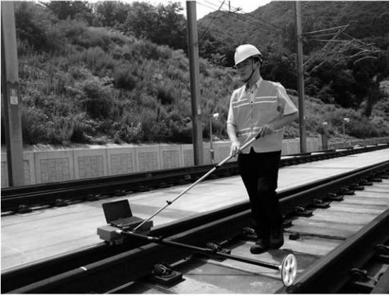
그림 4 철도 레일의 음향조도 측정 및 레일의 진동 측정을 통한 유효음향조도 추정
