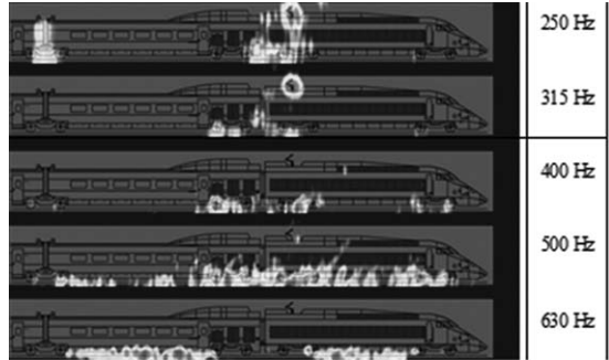
그림 9 측정 및 신호처리 통한 고속열차 소음원 위치 및 음향특성 결과 예
