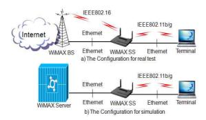
3. The Configuration for Routing Test 그림 3. 라우팅 테스트를 한 구성도
