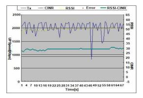
Fig 5. WiMAX Upstream performance 그림 5. WiMAX 상향 성능
