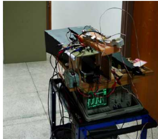
<그림 6> 제작된 FMCW 레이더의 실험 셋업
