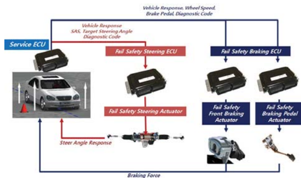
<그림 14> Fail Safety를 고려한 스마트 액추에이터 모듈
